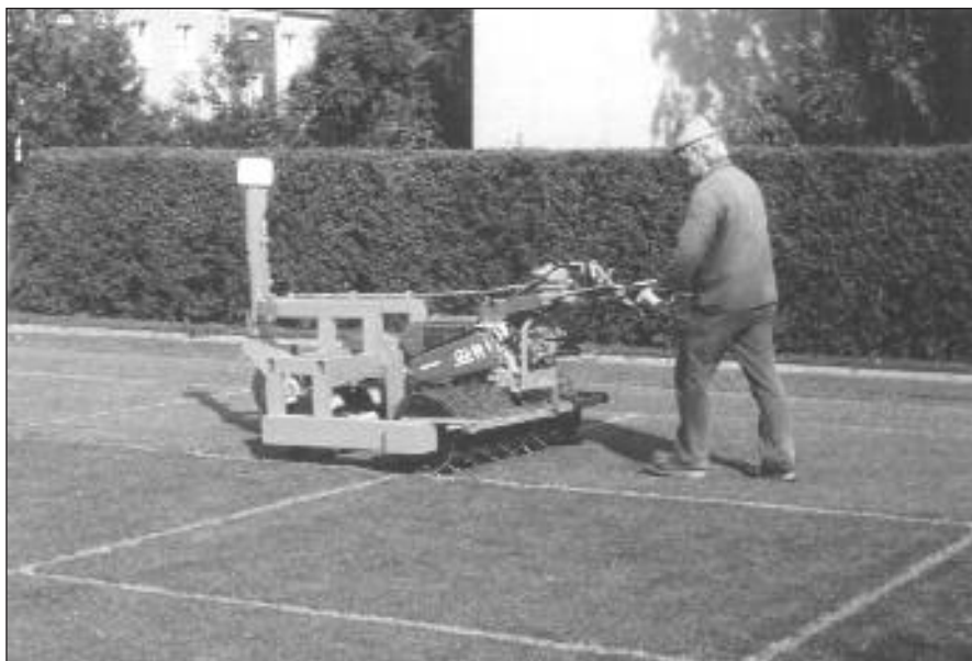
Abb. 3: Scher-Stollenwalze (Nachbau des BSA-Modells)
